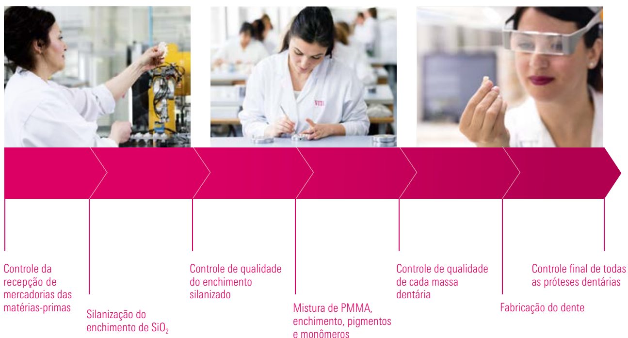
Figura 8: Processo para a fabricação de próteses dentárias VITA; Fonte: VITA P&D
