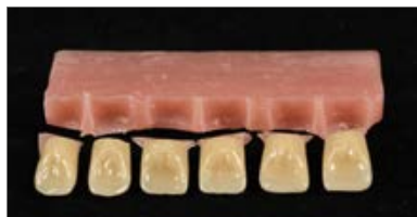
Figura 14 d: Padrão de fratura; A base de dente foi apenas umedecida com o agente adesivo
