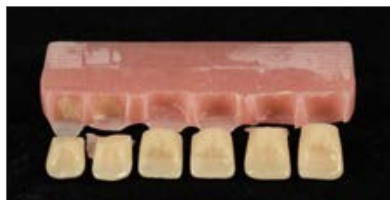
Figura 14 c: Padrão de fratura; Pré-tratamento da base do dente somente por jateamento
