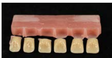
Рисунок 14 б: Рисунок разрушения; без предварительной обработки поверхности базиса зуба
