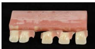
Рисунок 14а: Рисунок разрушения; базис зуба был подвержен пескоструйной обработке и покрыт адгезивным средством
