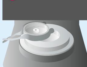
Sinterring entnehmen und mit Messschieber vermessen.
