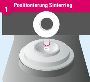
Sinterring ohne Sinterperlen zentrisch in der Sinterschale positionieren\*.
