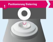
Sinterring ohne Sinterperlen zentrisch in der Sinterschale positionieren\*.
