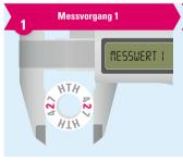
Durchmesser des Sinterrings an der mittleren Zahl messen (exemplarische Darstellung des Sinterrings).
