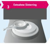
Sinterring entnehmen und mit Messschieber vermessen.
