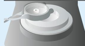
Retirar el anillo de sinterización y medirlo con un pie de rey.
