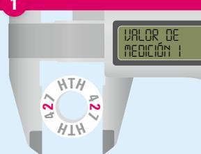
Medir el diámetro del anillo de sinterización en la cifra central (imagen de ejemplo del anillo de sinterización).
