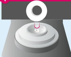
Posicionar en el centro de la bandeja de sinterización el anillo de sinterización sin perlas de sinterización\*.
