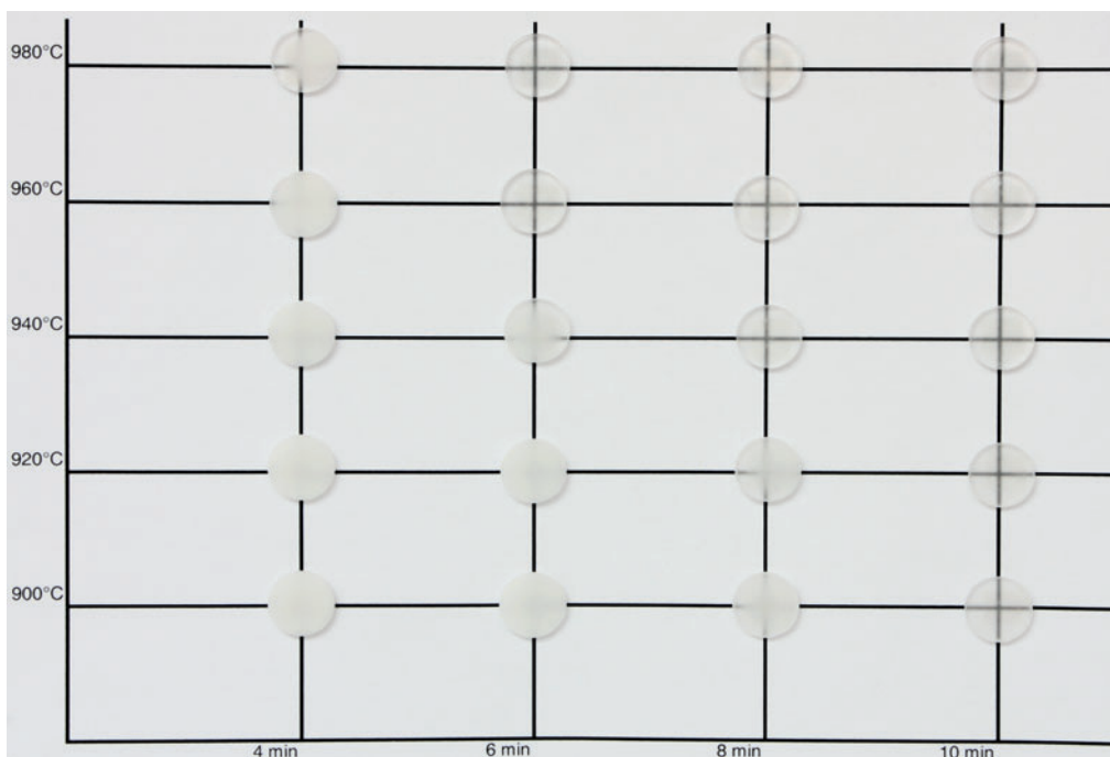
Abb. 6 Beispiel für Brennpföchten mit einer Verblendkeramik (Window Masse).
