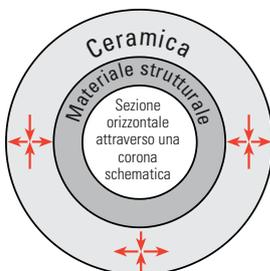
La situazione ottimale si ha quando la ceramica di rivestimento presenta un coefficiente di espansione termica leggermente più basso di quello del materiale strutturale. Essendovi un legame adesivo, la ceramica deve seguire il comportamento termico del materiale strutturale. Durante il raffreddamento la ceramica viene sottoposta ad una leggera tensopressione tangenziale.
