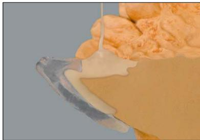
**Fig. 1:** La imagen de la sección muestra la distribución homogénea y sin burbujas del material gracias a su fluidez.
