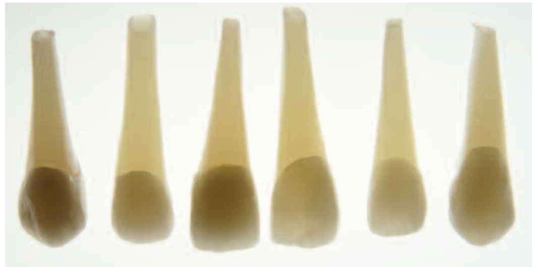
Abb. 9 Im Durchlicht zeigt sich Lichtleitfähigkeit der PM 9
