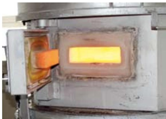
Abb. 6: Die Blöcke werden bei über  $1.000^{\circ}\text{C}$  gebrannt.
