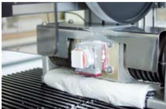
Abb. 21: Einzelne Blöcke werden mit einer Diamantdrahtsäge zu Biegestäbchen zerteilt...
