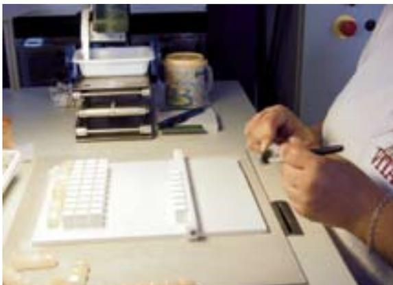
Abb. 15: Die Blöcke werden vor dem Brennen mit einer Pinselquaste von möglichen Verunreinigungen befreit.
