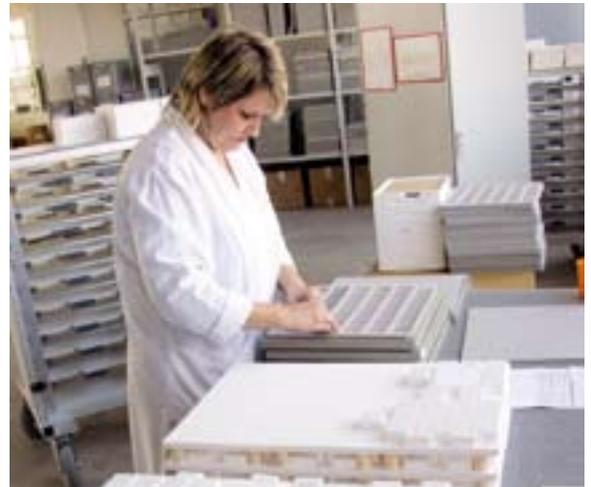
Abb. 16: Vor der Weiterleitung zu den Konfektionierungsmaschinen werden fehlerhafte Blöcke aussortiert.
