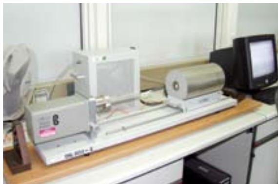
Abb. 23: Durch Thermoanalysen wird der WAK kontrolliert.
