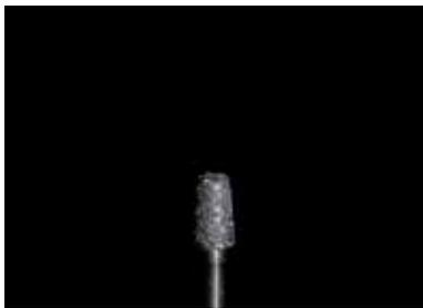
Der konische Inlaydiamant garantiert durch seinen Durchmesser von 1,5 mm, dass die Mindestschichtstärken der Keramik nicht unterschritten werden.
