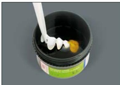
Die Restauration wird entsprechend der zu reproduzierenden Farbe in die Färbeflüssigkeit getaucht. Das Gerüst so in die Flüssigkeit legen, dass keine Luftbläschen vorhanden sind und es vollständig mit Liquid bedeckt ist. Die empfohlene Tauchzeit beträgt 2 Minuten. Beim Tauchen kann unterstützend auch Vakuum oder Druck (2 bar) eingesetzt werden.
