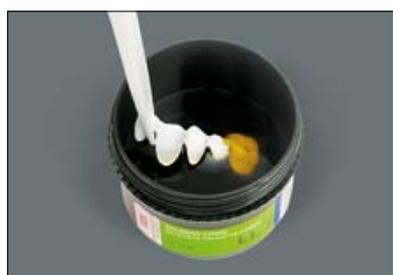
Sumergir la restauración en el líquido colorante correspondiente al color que se desee reproducir. Introducir la estructura en el líquido de manera que no queden burbujas de aire y esté completamente cubierta de líquido. El tiempo de inmersión recomendado es de 2 minutos. Adicionalmente, puede utilizarse vacío o presión (2 bares) durante la inmersión.
