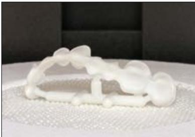
En los diseños de puentes extensos, se crean diferentes tipos de soportes de sinterización (dependiendo del software) para garantizar una sinterización sin deformaciones. No obstante, si este soporte se compone únicamente del resto del bloque o disco, deberá reducirse su volumen, en la medida de lo posible, para poder garantizar un calentamiento uniforme durante el proceso de sinterización.
