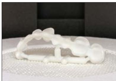
En présence de bridges à grande portée, on utilise en fonction du logiciel différents types de supports de frittage afin de garantir un frittage sans déformation. Si toutefois ce support se compose uniquement du reste du bloc/disque, il faut alors bien le réduire afin d'avoir la garantie d'un chauffage régulier lors du frittage.
