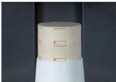
Para garantir uma queima perfeita dos componentes orgânicos do líquido para a coloração, as restaurações coloridas com YZ COLORING LIQUID no VITA ZYRcomat T devem ser preferencialmente sinterizadas sobre um cadinho de sinterização apropriado (Art. n.º: E38011 / E38014).
