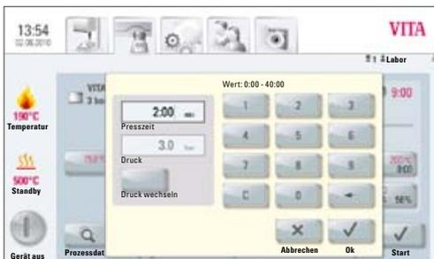
Bild 1 zeigt Eingabemöglichkeit der Presszeit und des Pressdrucks
