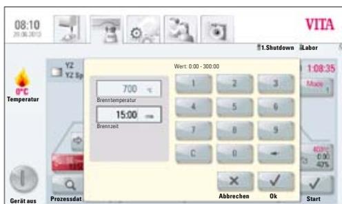
Bild 2 Eingabe Brenntemperatur und Brennzeit für Haltezeit 1
