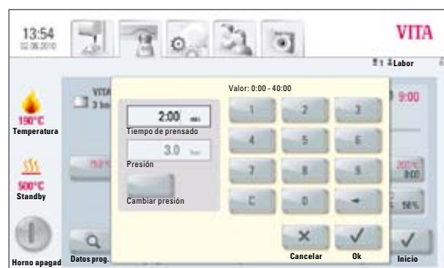
La figura 1 muestra la introducción del tiempo de prensado y de la presión de prensado
