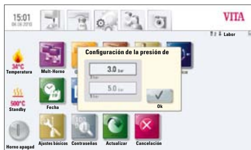
Figura 1 Ajuste de la presión de prensado
