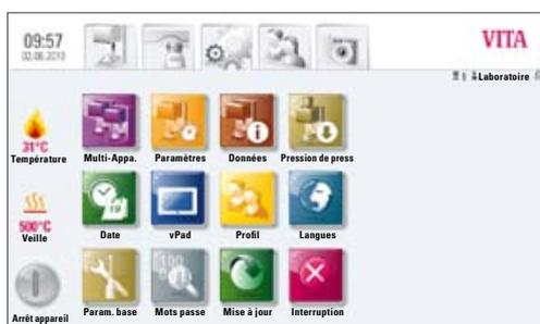
Fenêtre 2 Écran d'affichage des réglages d'un four de pressée combiné
