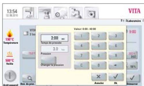
Fenêtre 1 Entrée des temps et pression de pressée
