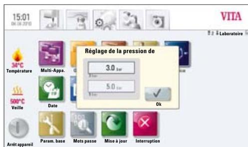
Fenêtre 2 Réglage de la pression de pressée
