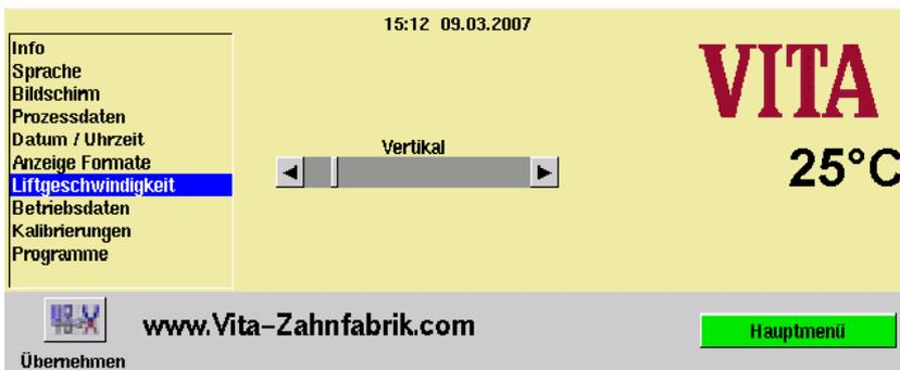
Скорость движения лифта устанавливается с помощью передвижного регулятора.
