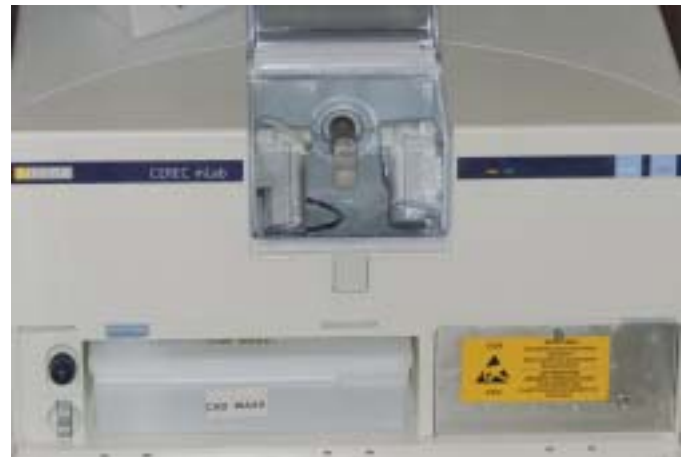
Abb. 6 Der eingespannte CAD-Waxx Block im umgerüsteten Cerec inLab
