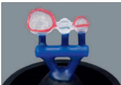
Wie aus der Gusstechnik bzw. Presstechnik gewohnt, wird das Formteil mit Wachsgussstiften versehen und auf den Gusstrichterformer aufgewachst. Hierbei sind die Vorschriften der Legierungshersteller bzw. Presskeramik-Hersteller zu beachten.
