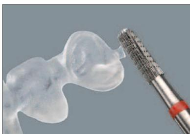
Nach dem Schleifvorgang (CAM), Abstichzapfen mit einem feinen kreuzverzahnten Hartmetallfräser (roter Ring) entfernen.
