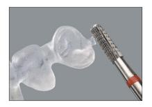
Después del proceso de tallado (CAM), retirar los restos de unión con una fresa fina de dentado cruzado de carburo de tungsteno (anillo rojo).
