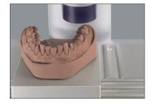
Colocar el modelo de yeso escaneable en la mesa de escaneo del inEos y realizar el proceso de escaneado.\*
