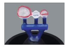
Al igual que en las técnicas de colado y de cerámica prensada, la pieza se fija mediante cera a los bebederos y al cono de colado.
