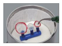
Realizar el revestimiento conforme a las especificaciones del fabricante del material de revestimiento y colocar en el horno de precalentamiento.
