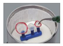
Mettre en revêtement la pièce à couler conformément aux indications du fabricant de revêtement et introduire dans le four de préchauffage.
