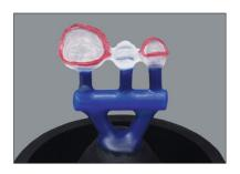
Comme il est d'usage dans la technique de coulée ou la technique de pressée, mettre des tiges de coulée sur la structure et fixer cette dernière avec de la cire sur le réservoir de coulée. Pour cette opération, respecter les consignes du fabricant d'alliage ou de céramique pressée.
