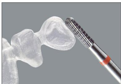
I bordi marginali fresati in spessore maggiorato vanno ridotti con una fresa in metallo duro a taglio incrociato fine (anello rosso). In caso di elementi completamente anatomici occorre controllare l'occlusione.
