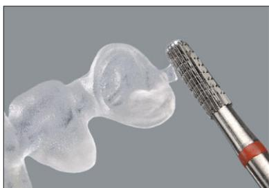
После фрезеровки (CAM), держатель блока срезается с помощью твердосплавной фрезы с тонкой крестообразной насечкой (красное кольцо).
