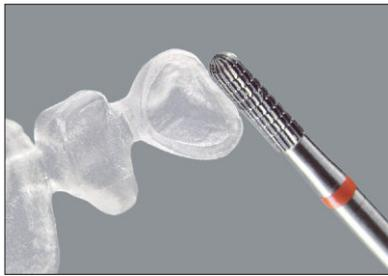
Утолщено отфрезерованные маргинальные кромки обрабатываются с помощью твердосплавной фрезы с тонкой крестообразной насечкой (красное кольцо). При исполнении анатомических моделей необходимо проверить окклюзию.
