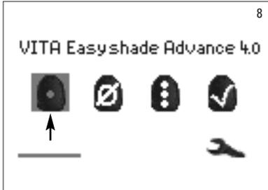
Après étalonnage, le menu de mesure s'affiche (ill. 8) et l'appareil est prêt à fonctionner. Le dernier mode de mesure utilisé a été automatiquement mémorisé et sera activé en appuyant sur la touche Sélection.
