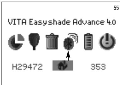
Pour établir une connexion avec un ordinateur, il faut allumer le module Bluetooth et brancher le module USB Bluetooth fourni avec l'appareil dans une prise USB de votre ordinateur. Au premier raccordement, Windows à partir de la version XP installe automatiquement le pilote. Pour la transmission des données à l'ordinateur, utilisez aussi le logiciel VITA Assist fourni avec le VITA Easyshade Advance 4.0.
