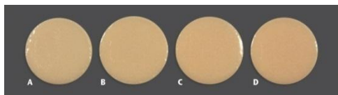
Fig. 2 Claras diferencias de color causadas por tiempos de presecado distintos con la misma cerámica: A: sin presecado, B: 2 min, C: 4 min, D: 6 min
