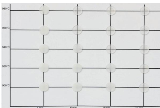
Рис. 4 Образцы керамики (масса Window) с различной степенью обжига в зависимости от времени нагрева (ось x) и температуры (ось y).
