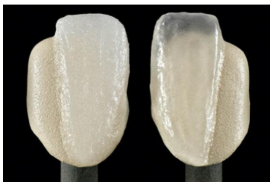
Рис. 8 Сравнение неправильно обожженной (слева) (недостаточный обжиг, плохой вакуум) и идеально обожженной (справа) коронки с массой Window системы VITA VM13.
