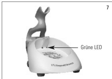
Setzen Sie hierfür das Gerät so in den Kalibrierblockhalter ein, dass die Spitze bündig und im rechten Winkel zum Kalibrierblock aufliegt und den Kalibrierblock nach unten drückt (Abb. 6). Vergewissern Sie sich, dass das Handstück vollständig im Kalibrierblockhalter sitzt.
