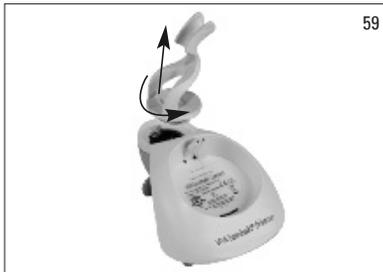
VITA Easyshade Advance 4.0 darf nur mit einer neuen Infektionsschutzfolie kalibriert werden. Falls der Kalibrierblock verunreinigt wird, muss der Kalibrierblock mit dem Halter von der Basisstation entfernt und in einem Dampfautoklav nach den Vorgaben des Herstellers des Sterilisationsmittels sterilisiert werden. Verwenden Sie keinen „Heat only“ Autoklav.
