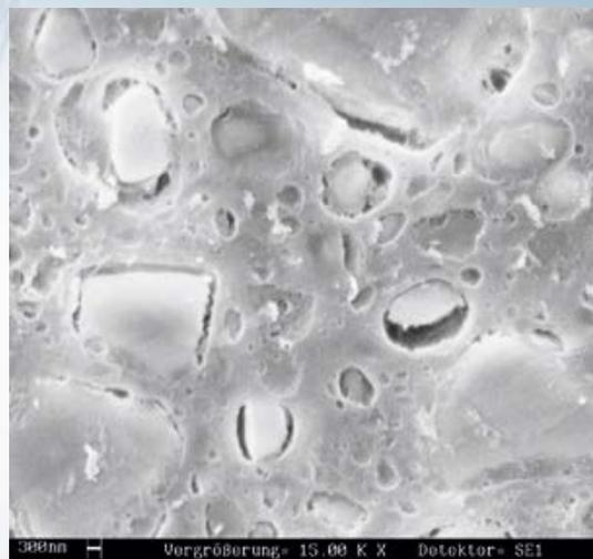
**Fig. 2** Fuente: Dpto. de I+D de VITA, superficie de composite grabada
