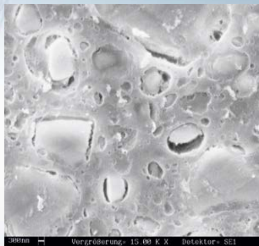
2. kép Forrás: VITA K+F, Savazott kompozit felület Kompozit: Polimer, kerámia töltőrészecskéekkel
