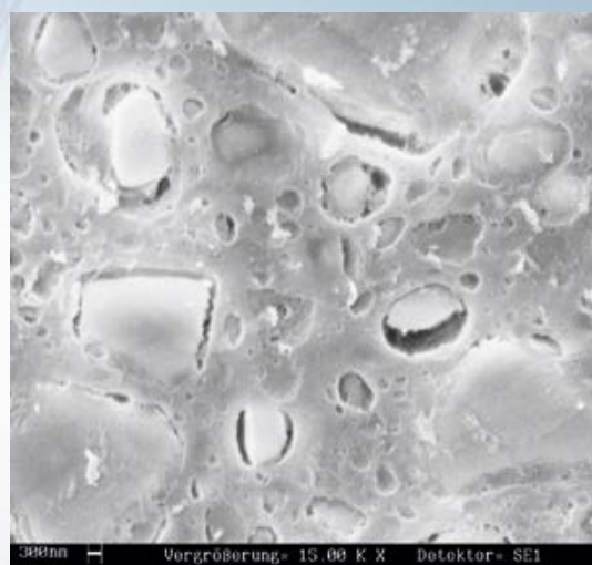
Fig.2 Fonte: VITA R&S, superficie mordenzata di composito Composito: polimero con particelle ceramiche di carica
