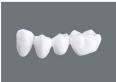
Restauracije posle glodanja/brušenja CAM procesom. Obradni stubići su već uklonjeni i brušenjem su izvršene potrebne korekcije.
