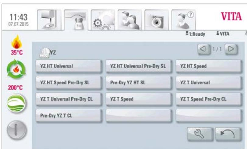
VITA YZ HT programi sa završnom temperaturom sinterovanja od **1450 °C**:
