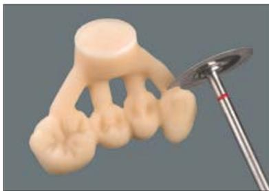
Odvajanje presovanog objekta od kanala za presovanje obaviti oštrijim dijamantnim brusnim diskom pod blagim pritiskom.
