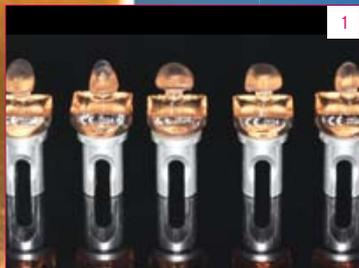
Abb. 1 Kohlinge aus der zirkondioxidverstärkten Lithiumsilikatkeramik VITA SUPRINITY ...
