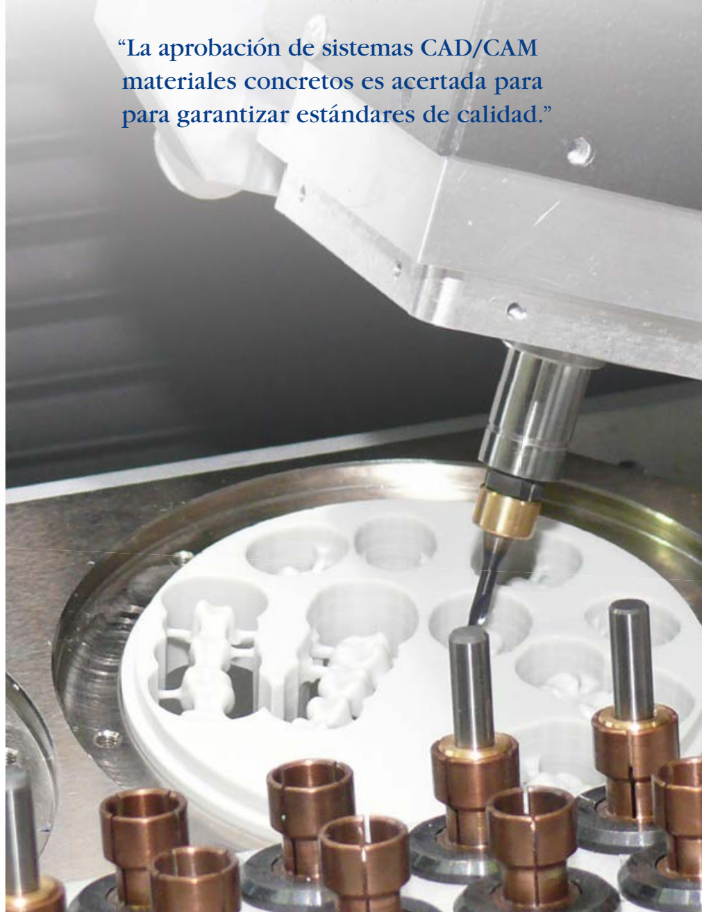
Fig. 4 Pulido de una corona monolítica de cerámica híbrida.
