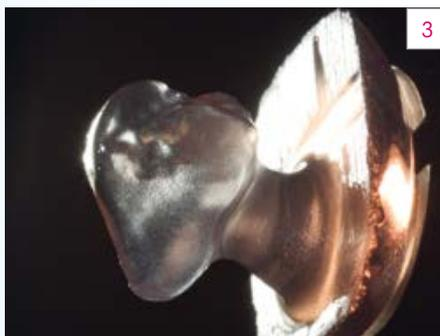
Fig. 3 Restauro in VITA SUPRINITY immediatamente dopo il processo di molaggio.
