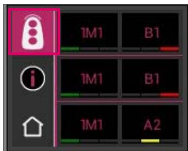
Пренасяне на резултати от измервания чрез Bluetooth® посредством докосване на символа Режим. Препращането на данни е възможно във всички измервателни режими и в режим Запаметяване. Резултати от измервания в режим Възстановявания могат да се пренасят само към VITA ShadeAssist на Windows-PC.
