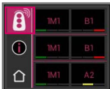
Pro přenos dat na přístroje s Windows a Android se musí VITA Easyshade® V spojít s přístrojem. Stávající spojení se zobrazí u symbolu režimu měření jako vlna. U přístrojů s iOS se spojení před přenosem automaticky naváže a potom opět přeruší.
