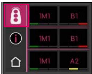
Trasmissione dei risultati di misura via Bluetooth® toccando il simbolo modo di funzionamento. La trasmissione è possibile in tutte le modalità di misura e in modalità di memorizzazione. Risultati di misura in modalità restauro possono essere trasmessi solo al VITA ShadeAssist su PC Windows.
