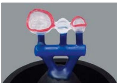
Wie aus der Gusstechnik bzw. Presstechnik gewohnt, wird das Formteil mit Wachsgusstiften versehen und auf den Gusstrichterformer aufgewachst. Hierbei sind die Vorschriften der Legierungs-Hersteller bzw. Presskeramik-Hersteller zu beachten.
