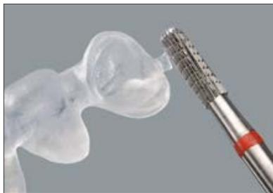
Nach dem Schleif-/Fräsvorgang (CAM), Abstichzapfen mit einem feinen kreuzverzahnten Hartmetallfräser (roter Ring) entfernen.
