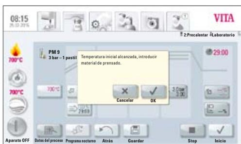
Fig. 6. Vista en pantalla al alcanzarse la temperatura inicial
