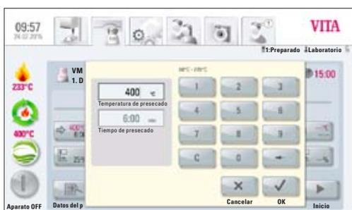
Fig. 4. Introducción de la temperatura y del tiempo de presecado
