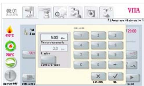
Fig. 4. Introducción del tiempo de prensado y de la presión de prensado
