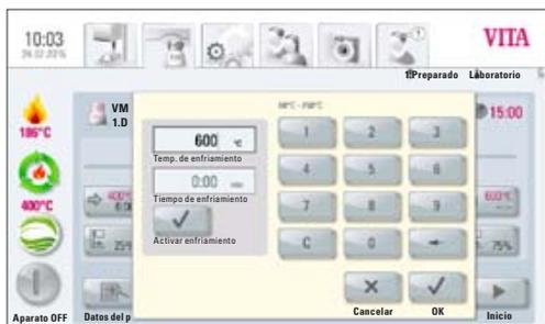
Fig. 11. Introducción de los parámetros de enfriamiento
