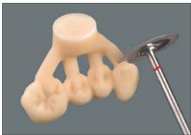
Per staccare il lavoro pressato dal canale di pressatura usare un disco diamantato tagliente ed esercitare pressione ridotta.
