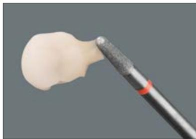
La finitura della sovrastruttura di rivestimento si esegue con diamantate a granulometria fine.
