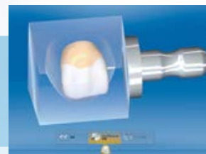
4. Posizionamento del restauro coronale prima del fresaggio.
