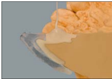
Abb. 1: Der Querschnitt zeigt ein blasenfreies, gleichmäßiges Ausfließen aller Bereiche.
