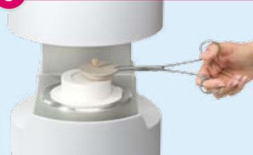
Colocar el soporte de cocción con la restauración en el zócalo de cocción.
