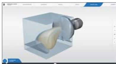
Como **posição inicial** em relação a todos os eixos, a restauração é posicionada no centro do bloco através do software. O lado labial/vestibular aponta para a zona de esmalte do bloco. Ele é coberto 75% com esmalte.
