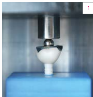
III. 1 Les couronnes ont été soumises à des contraintes jusqu'à rupture.
