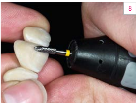
III. 8 Mise en forme avec des fraises en métal dur et des polissoirs caoutchouc.
