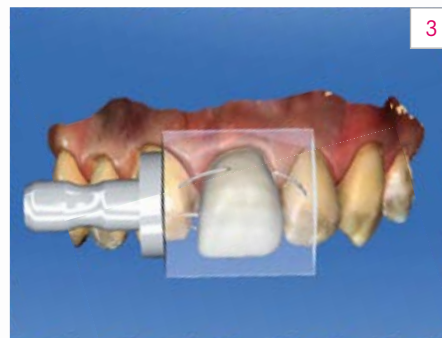
III. 3 Positionnement de la construction dans le bloc.
