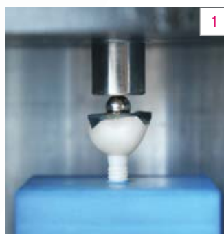
Fig. 1 Le corone sono state sottoposte a carico fino a rottura.
