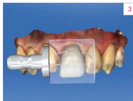
Fig. 3 Posizionamento della progettazione nel blocchetto.
