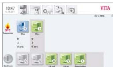
Фото 2. Стартовая картинка, отображающая подключение с двумя печами VITA New Generation
