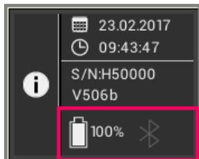
El campo inferior indica el estado de la batería, así como el estado de Bluetooth. Si el símbolo de Bluetooth se muestra en gris, significa que el Bluetooth está desactivado. Si el símbolo de Bluetooth aparece en blanco, significa que el Bluetooth está activado, pero no está conectado a ningún dispositivo.
