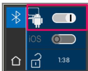
Instale la aplicación VITA mobileAssist (disponible gratuitamente en Google Play Store). Acceda a los ajustes de Bluetooth de su VITA Easyshade V. Para activar el Bluetooth, deslice hacia la derecha el mando deslizante superior para Windows/Android. Se abrirá automáticamente el símbolo del candado y el VITA Easyshade V permanecerá detectable durante dos minutos. Si el símbolo del candado estuviera cerrado, puede tocarlo para volver a hacer detectable el VITA Easyshade V.
