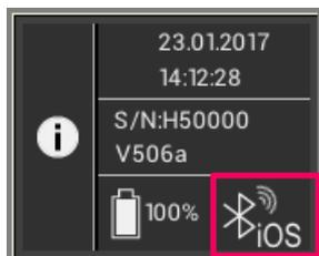
Si el VITA Easyshade V está conectado a un ordenador con Windows o a un dispositivo Android, se muestran ondas de radio junto al símbolo de Bluetooth en la parte superior derecha. Si el VITA Easyshade V está conectado a un dispositivo iOS, además de las ondas de radio se indica “iOS” en la parte inferior derecha junto al símbolo de Bluetooth. Al tocar el símbolo de Bluetooth accederá directamente a los ajustes de Bluetooth, donde podrá realizar modificaciones.
