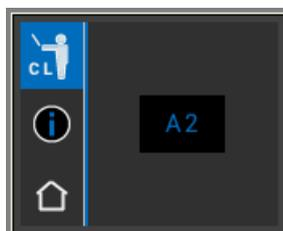
Per la misura appoggiare perfettamente la punta sul terzo superiore (sotto il colletto) del campione colore esercitando una leggera pressione. Azionare il tasto di misura. Viene visualizzato il colore più vicino.
