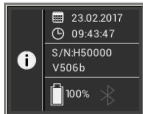
Toccando „Data e ora“ nel campo superiore, si accede direttamente alla regolazioni, dove è possibile modificare data e ora. Nel campo centrale sono visualizzati il numero di matricola e la versione software.
