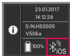
Se VITA Easyshade V è accoppiato con un PC Windows o un dispositivo Android, in alto a destra di fianco al simbolo Bluetooth appaiono delle onde radio. Se VITA Easyshade V è accoppiato con un dispositivo iOS, in basso a destra di fianco al simbolo Bluetooth oltre alle onde radio appare „iOS“. Toccando il simbolo Bluetooth si accede direttamente alle regolazioni Bluetooth per effettuare modifiche.
