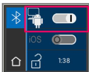
Accedere alle regolazioni Bluetooth. Spostare il cursore Bluetooth superiore per Windows/Android verso destra, per attivare Bluetooth. Il simbolo lucchetto si apre automaticamente rendendo VITA Easyshade V visibile per due minuti. Se il lucchetto fosse chiuso, toccarlo per rendere nuovamente visibile VITA Easyshade V.
