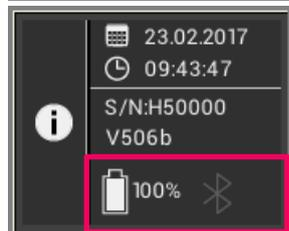
Nel campo inferiore vengono visualizzati lo stato della batteria e del Bluetooth. Se il simbolo Bluetooth è grigio, il Bluetooth è disattivato. Se il simbolo Bluetooth è bianco, il Bluetooth è attivato, ma non ancora accoppiato con un dispositivo.
