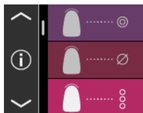
Toccando il simbolo **i** nel menu principale, si accede alle informazioni sull'apparecchio. Qui vengono visualizzati data e ora, numero di matricola, versione Software, stato di carica della batteria e stato Bluetooth.
