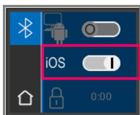
Installare VITA mobileAssist (disponibile gratuitamente nell'App Store). Accedere alle Regolazioni Bluetooth del proprio VITA Easyshade V. Spostare il cursore centrale iOS verso destra, per attivare Bluetooth. Il simbolo lucchetto si apre automaticamente rendendo visibile VITA Easyshade V per due minuti. Se il lucchetto fosse chiuso, toccarlo per rendere nuovamente visibile VITA Easyshade V.
